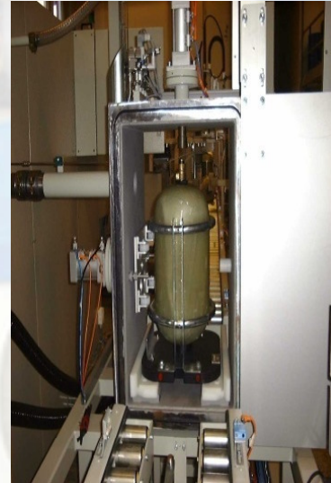
Control de Calidad Prueba a presión Presión Neumatica (33bar) & Prueba de Estanquidad (18bar Con helium)
