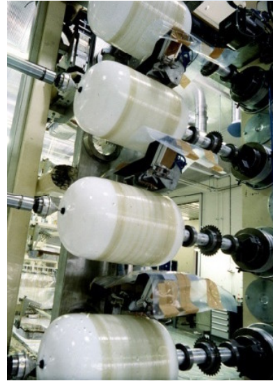
Capa de Fibra de Vidrio Bobinado de Fibra Y Curación en Horno
