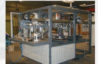
Encubrimiento HDPE Inyección de plastico 3 componentes & Montaje Mecanico
