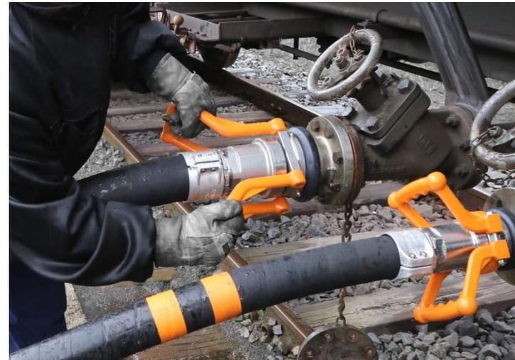
Carga GLP com DGC 3" (fase líquida) e recuperação vapor em 2". Acima vagão tanque com sistema de Acople a seco + Break-away. A direita outras transferências com sistema a seco.
