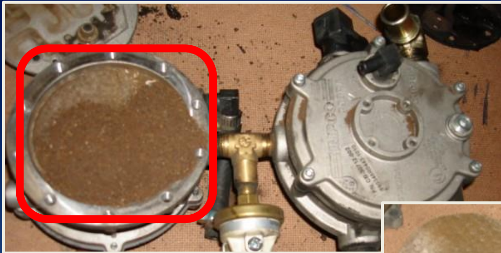
Redutor Vaporizador desmontado, utilizado no sistema da empilhadeira.
