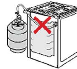
Garrafa con la manguera pasando por detrás de la cocina
